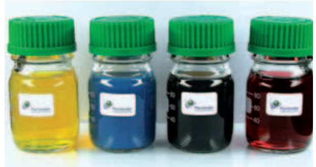
Durch ein verfeinertes Verfahren des Laserabtrags produziert Particular Nanopartikel nach den Wünschen der Kunden. Foto: Particular
